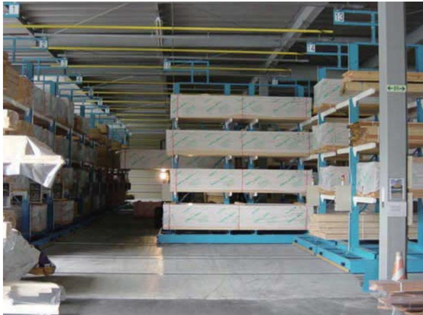
環境にやさしいプレカット工場を目指して、福島県ゼロ・エミッションに参加し、廃棄物を一切出さない企業・環境づくりを行っています。プレカットの生産力は月間10,000坪の能力を持ち、あらゆるの住宅工法に対応した設備を整えています。プレカットで使用する木材の保管に手前にせり出してくる縦移動方式の移動バラックをご採用いただきました。小口から全ての材種が見えるので過剰在庫を抑制することができます。
