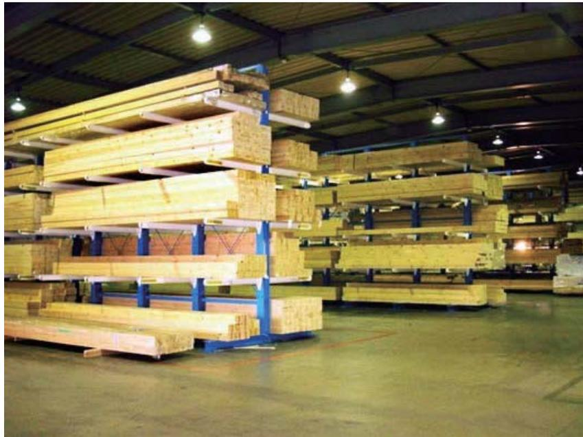
在来プレカット工場。プレカットの材料を材種別に保管・管理するため固定バラックをご採用頂きました。
